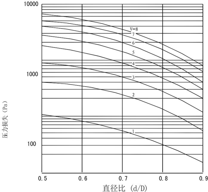
图4 安装渐缩管、渐扩管造成的压力损失
