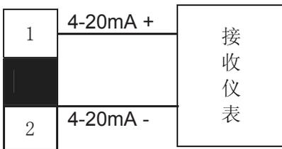
本转换器电流输出已实现电隔离, 输出采取有源方式。电流值由参数项“刻度流量值”所决定(可参见仪表出厂铭牌上的测量范围一值)。电流输出允许的最大负载电阻为 $750\ \Omega$ , 该负载电阻包括了所使用的连接电缆的阻值。
