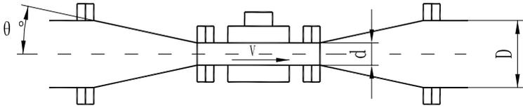
d、传感器内径；D、管径；V、传感器的流速（m/s）
